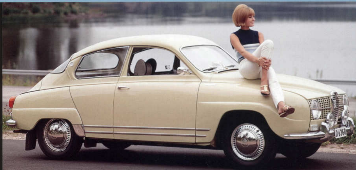
SAAB MONTE CARLO 850 ROČNÍKU 1962 S DVOUDOBÝM TŘÍVÁLEČEM 841
