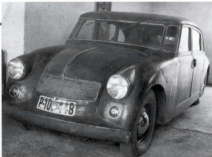
V roce 1937 postavil ing. Novotný aerodynamický vůz se dvěma motory
