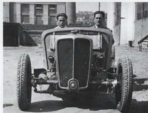
Břetislav (vpravo) a Hostivít (vlevo) zkoušejí triválec s předním pohonem
