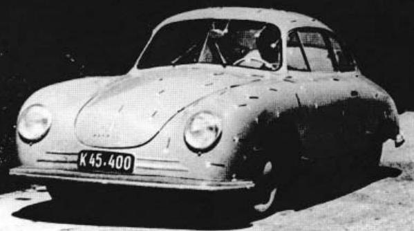
Jedno z prvních kupé Porsche 356/2 z Gmündu při aerodynamických zkouškách
