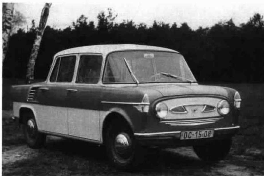
Š 989 s tzv. polovagonovou karosérií s předsunutým prostorem pro cestující.
