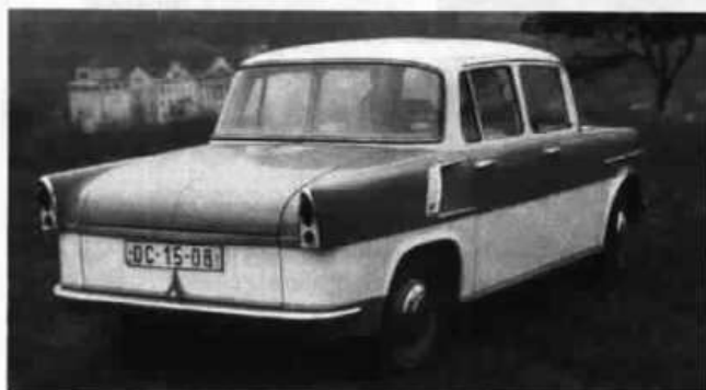
Š 989 s tzv. polovagonovou karosérií s předsunutým prostorem pro cestující.
