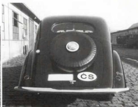
Plochá záď se zvenku připevněným náhradním kolem v návleku
