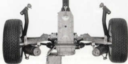
Transaxle (motor vpředu, za ním trubka s hřídelem a převodovka vzadu)
