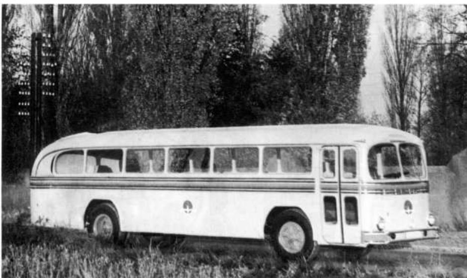
Druhý prototyp Š 706 RLS se samonosnou karosérií a ležatým motorem (1949)
