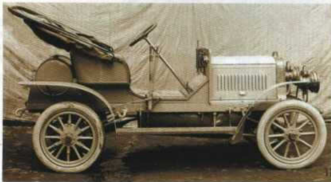
Laurin a Klement F 14/16 HP se čtyřválcovým motorem 2,4 l na obrázku z dobového prospektu
