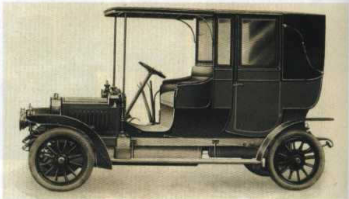
Skříňový dodávkový vůz typu F se čtyřválcovým motorem, určený pro londýnskou firmu Engelhardt
