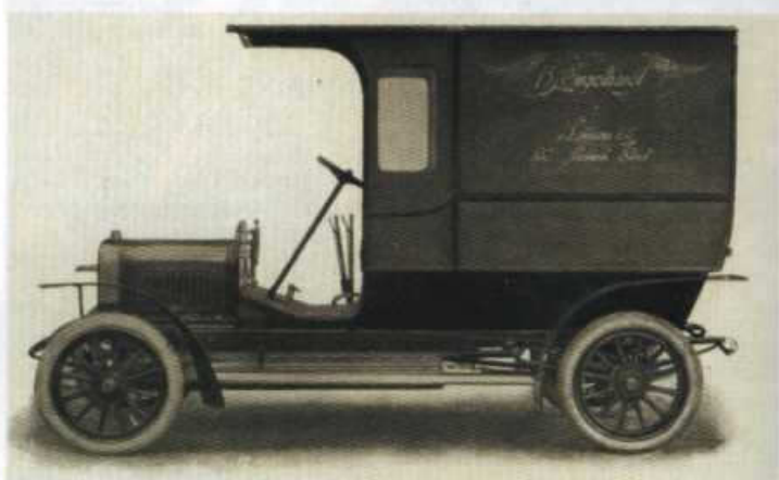
Skříňový dodávkový vůz typu F se čtyřválcovým motorem, určený pro londýnskou firmu Engelhardt
