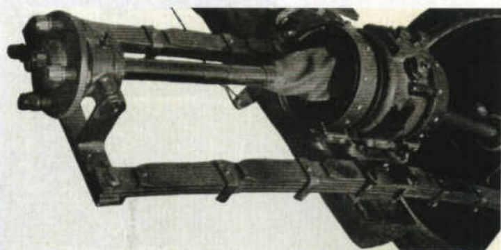
Původní zavěšení zadních kol s odpružením dvěma příčnými listovými perý.
