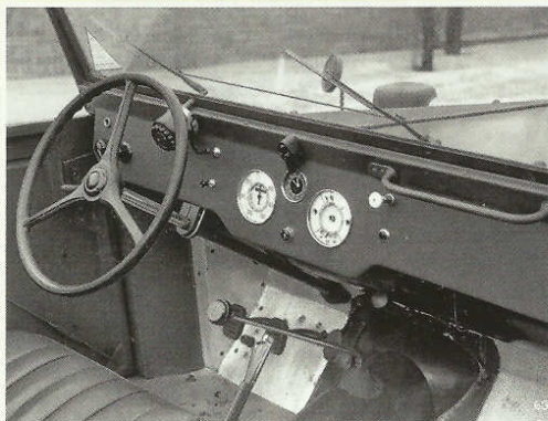
Strohá, ale dobře vybavená přístrojová deska vojenského typu 1101
