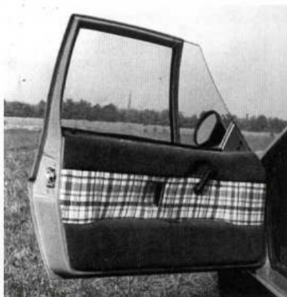
Originální, ale nepraktické řešení dveří s bezrámovým trojúhelníkovým okénkem
