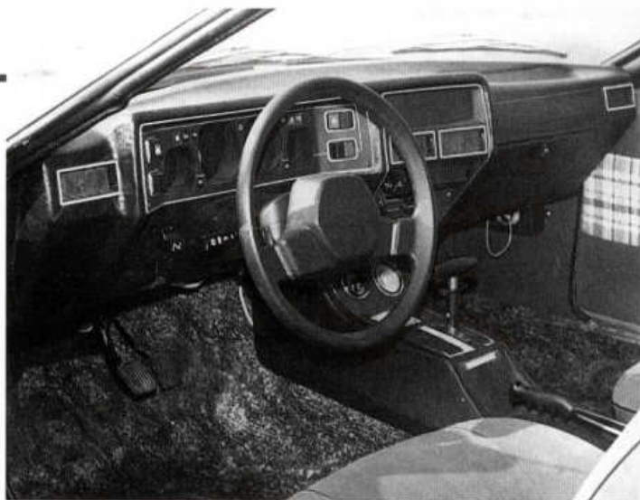
Dva pedály a volič na středním tunelu prozrazují samočinnou převodovku
