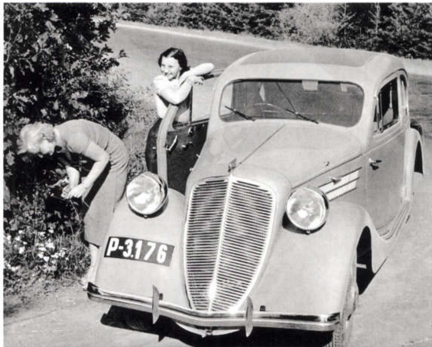
Přední kola vozu Z 5 Express poháněl dvoudobý čtyřválec 1,5 l
