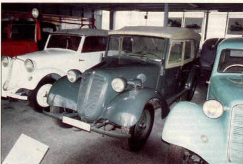
Vojenská Tatra 57 K s veškerou výstrojí proti nepohodě a s „protiletteckým“ polním světlometem.
