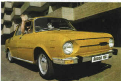
Škoda 100 L se zapuštěnými klikami a výše umístěným víčkem nádrže
