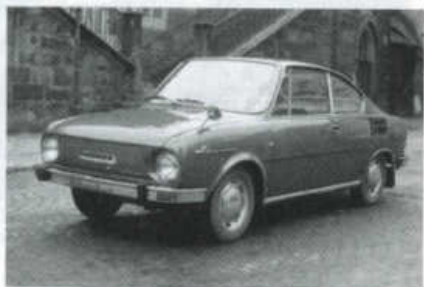
Škoda 100 L se zapuštěnými klikami a výše umístěným víčkem nádrže
