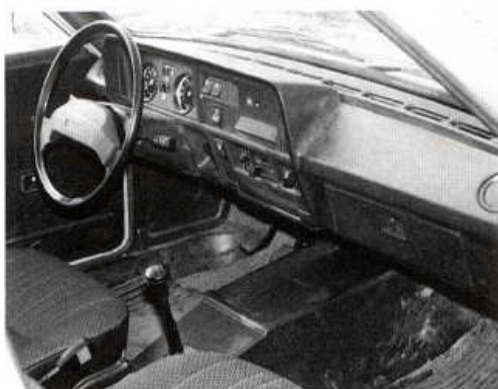
Volant, přístroje a ovládací prvky převzal P2 ze Škody 120
