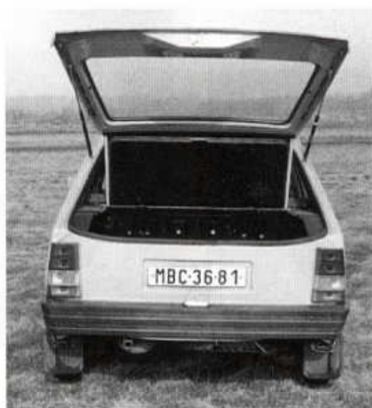
V otevřené poloze držela zadní víko P2 dvojice plynových vzpěr
