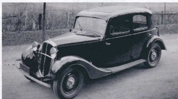
Sedan Škoda 420 Rapid s prodlouženým a zesíleným rámem a motorem 1,2 l (1934)
