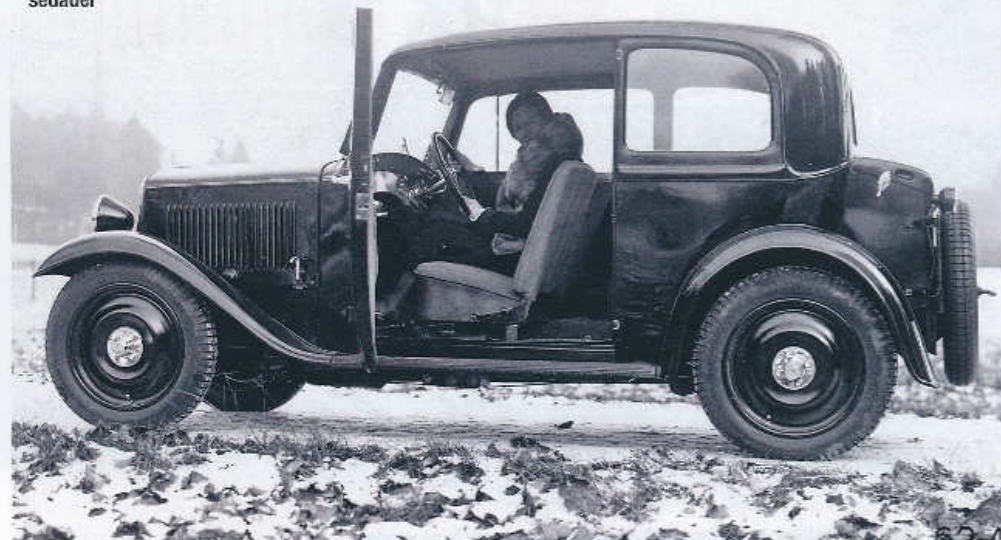
Tudor Škoda 420 měl dveře zavěšené vpředu a sklopná opěradla předních sedadel
