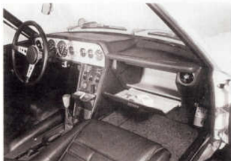
Přístrojová deska byla osazena sedmi kruhovými přístroji
