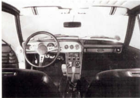
Přístrojová deska byla osazena sedmi kruhovými přístroji
