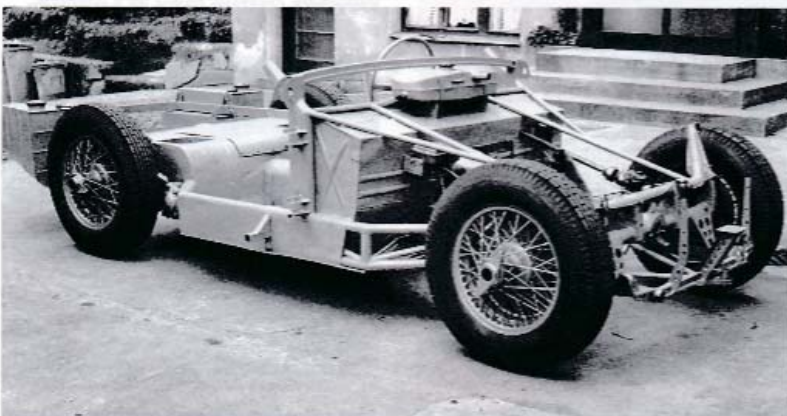
Podvozek JK 2500 s přední nápravou převzatou z vozu KdF
