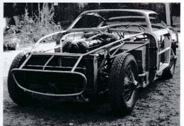
Za chladiči oleje a vody zprvu trůnil šestiválec DOHC Alfa Romeo
