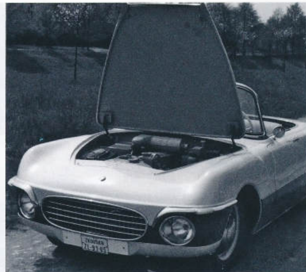
Pod lichoběžníkovou kapotou se skrýval sériový čtyřválec 1089 cm 3
