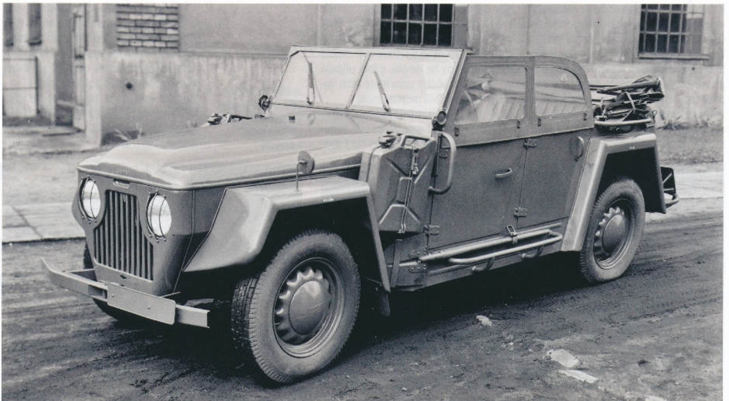
Škoda 1101 P opatřená dveřmi a na ně nasazenými slidovými okénky
