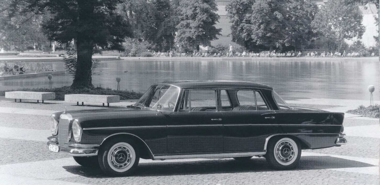
Mercedes-Benz 300 SEL měl o 100 mm prodloužený rozvor, délku a zadní dveře
