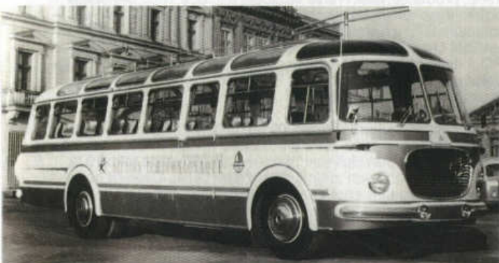
Luxusní verze autokaru RTO v provedení Brusel 1958 s prosklenou přední částí střechy a anténou TV.
