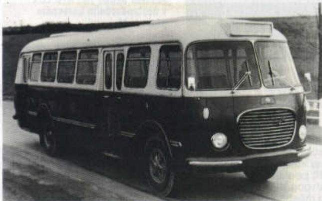
Městský autobus Škoda 706 RTO MTZ v tuzemském provedení s dvojicí dveří na pravém boku.
