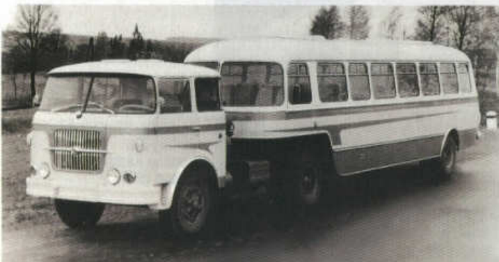
Prototyp autobusového návěsu RTO s tahačem Škoda 706 RT.
