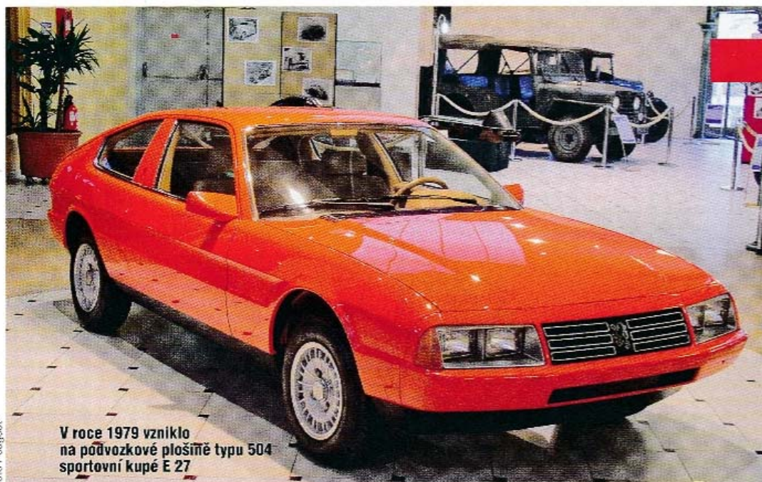
Kupé E 27 má vyklápěcí dveře v zádi a kliky bočních dveří na středních sloupcích
