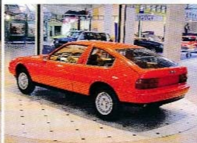
Kupé E 27 má vyklápěcí dveře v zádi a kliky bočních dveří na středních sloupcích
