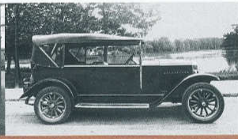
SÉRIOVÝ VŮZ VOLVO ÖV 4 SE ČTYŘVÁLCEM 1,9 L VYRÁBĚNÝ V LETECH 1927-29
