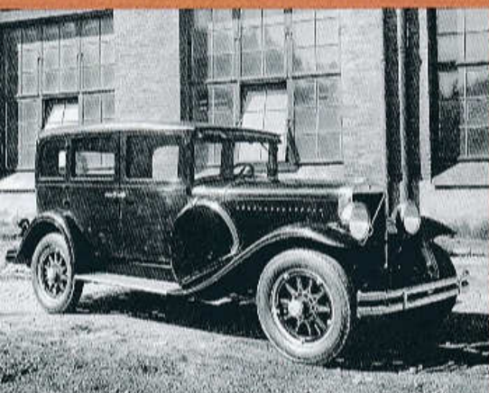
▼ V DUBNU 1929 DEBUTOVAL VŮZ VOLVO PV 651 S TŘILITRÝM ŠESTIVÁLCEM
