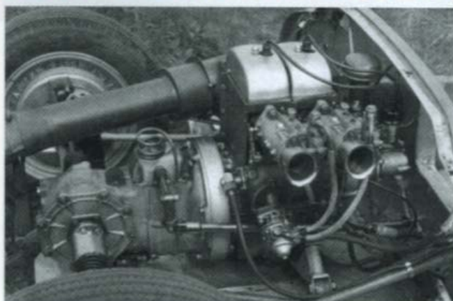
Řadový dvouválec 636 cm 3 byl osazen dvěma karburátory Weber
