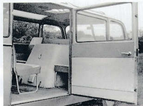
Pohled bočními dveřmi do vnitřku minibusu s odklopeným krytem osmiválcové (vlevo) Nalevo a napravo od krytu motoru byla sedadla obrácená zády ke směru jízdy (vpravo)
