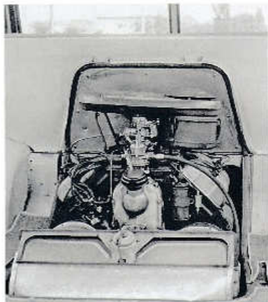
Vzduchem chlazený osmiválec do V byl uložen za sedadly řidiče a spolujezdce
