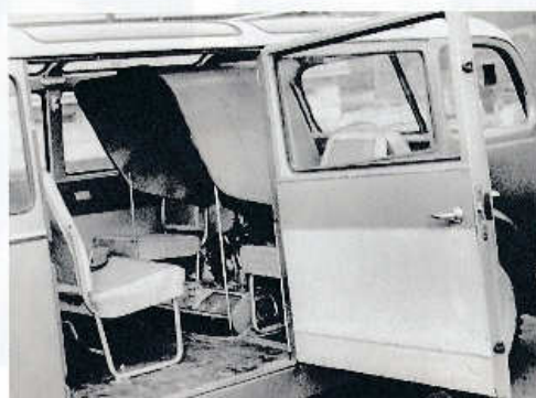
Pohled bočními dveřmi do vnitřku minibusu s odklopeným krytem osmiválcové (vlevo) Nalevo a napravo od krytu motoru byla sedadla obrácená zády ke směru jízdy (vpravo)
