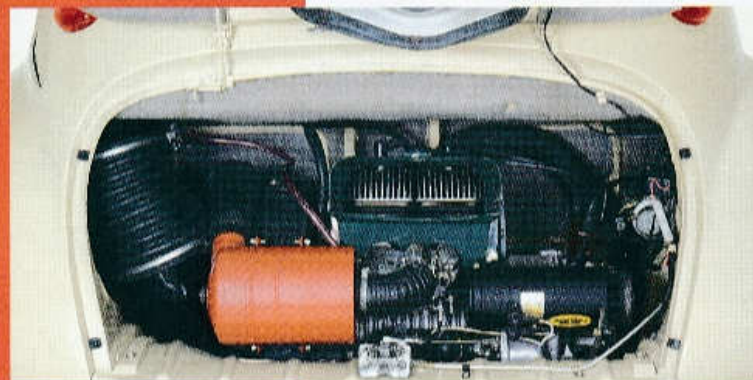
▼ VZADU NAPŘÍČ ULOŽENÝ VZDUCHEM CHLAZENÝ DVOUDOBÝ DVOUVÁLEC 356 CM 3
