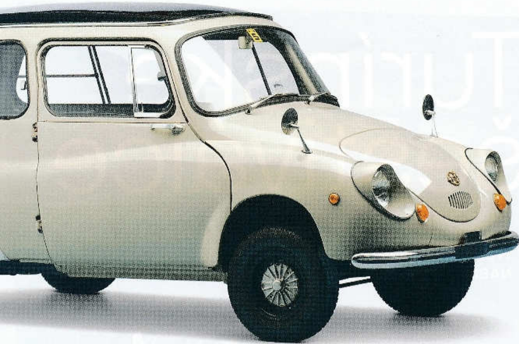
▲ TRÍMETROVÉ KOMBI SUBARU 360 CUSTOM S UŽITEČNOU HMOTNOSTÍ 250 KG
