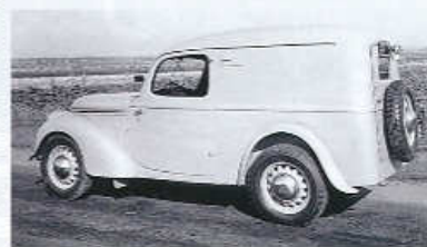
Dodávka se zesíleným podvozkem měla užitečnou hmotnost 500 kg (1939)
