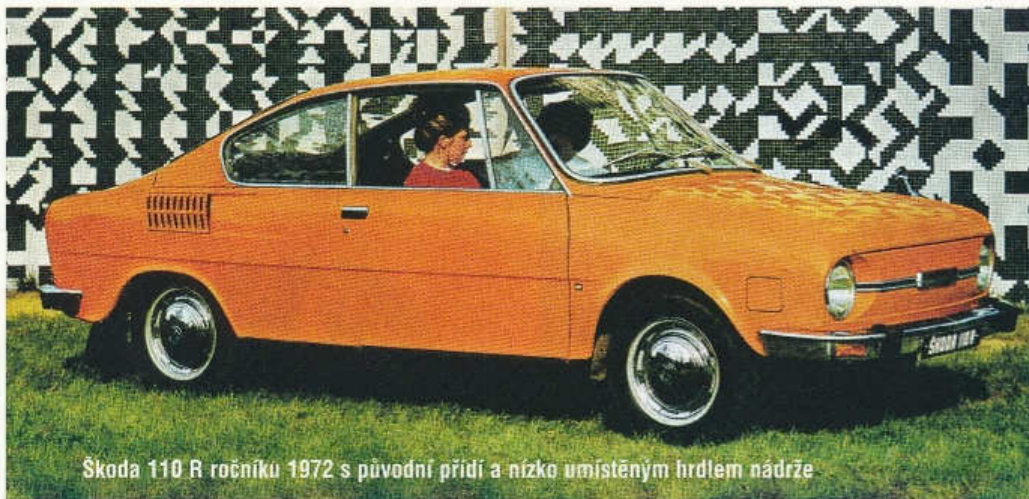
Pozměněné zadní čelo a mřížka odtažového větrání na zadním sloupku
