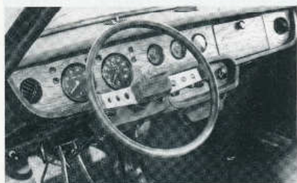
Přístrojová deska s kruhovými přístroji a obložením z polyuretanové pěny
