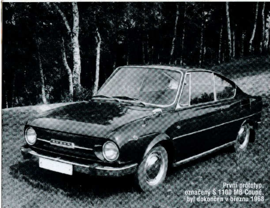
První kus měl pevné rámečky trojúhelníkových větracích okének ve dveřích
