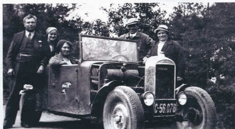
První automobil Hara ještě bez kapoty a s provizorním chladičem z vozu Amilcar
