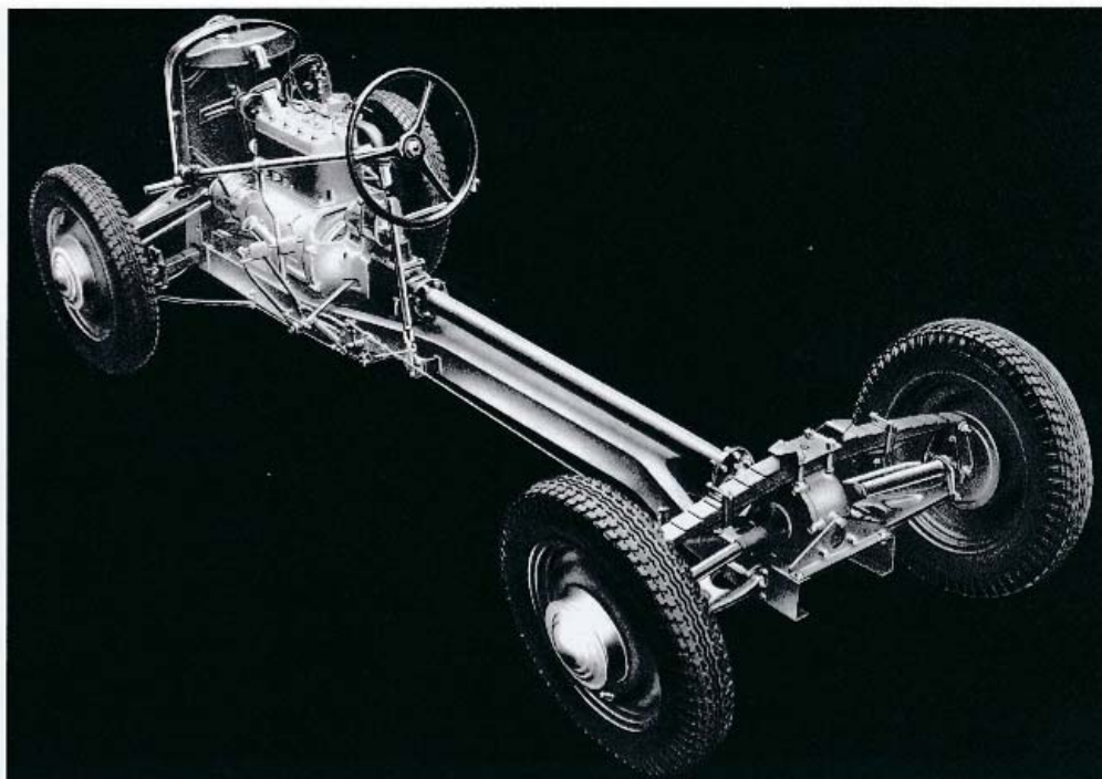
Podvozek typu Baby s nezávislým zavěšením všech čtyř kol (1934)
