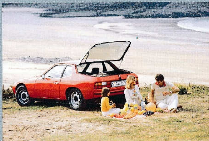
VYKLÁPĚCÍ ZADNÍ OKNO PORSCHE 924 BYLO OPATŘENO DVĚMA PLYNOVÝMI VZPĚRAMI
