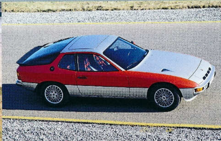
PORSCHE 924 TURBO S PŘEPLŇOVANÝM ČTYŘVÁLCEM 2,0 L O VÝKONU 170 K (1979)
