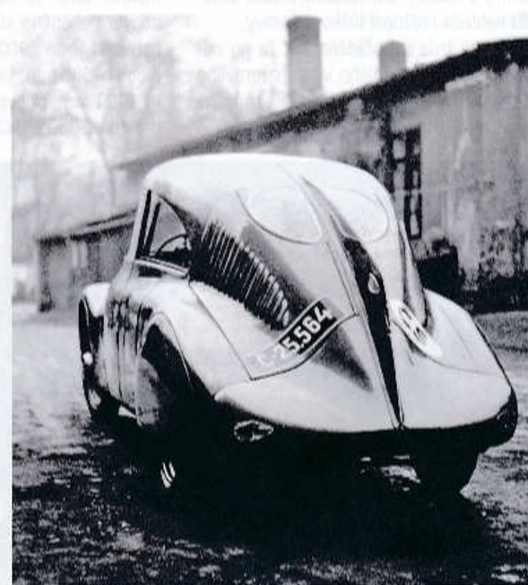
Podle dobové aerodynamické módy byla zád' opatřena svislou „ploutví“
