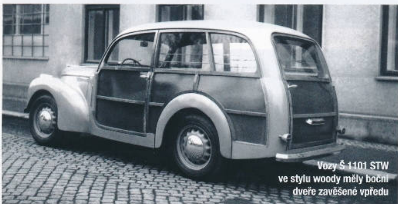
Skříňová Škoda 1101 Normand s dřevěnou kostrou karoserie (1948)
