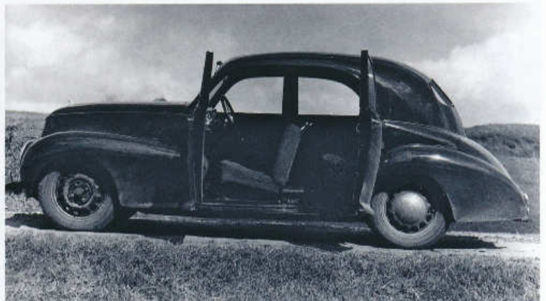
Čtyřdveřová karoserie prvního prototypu Rekord neměla střední sloupky
