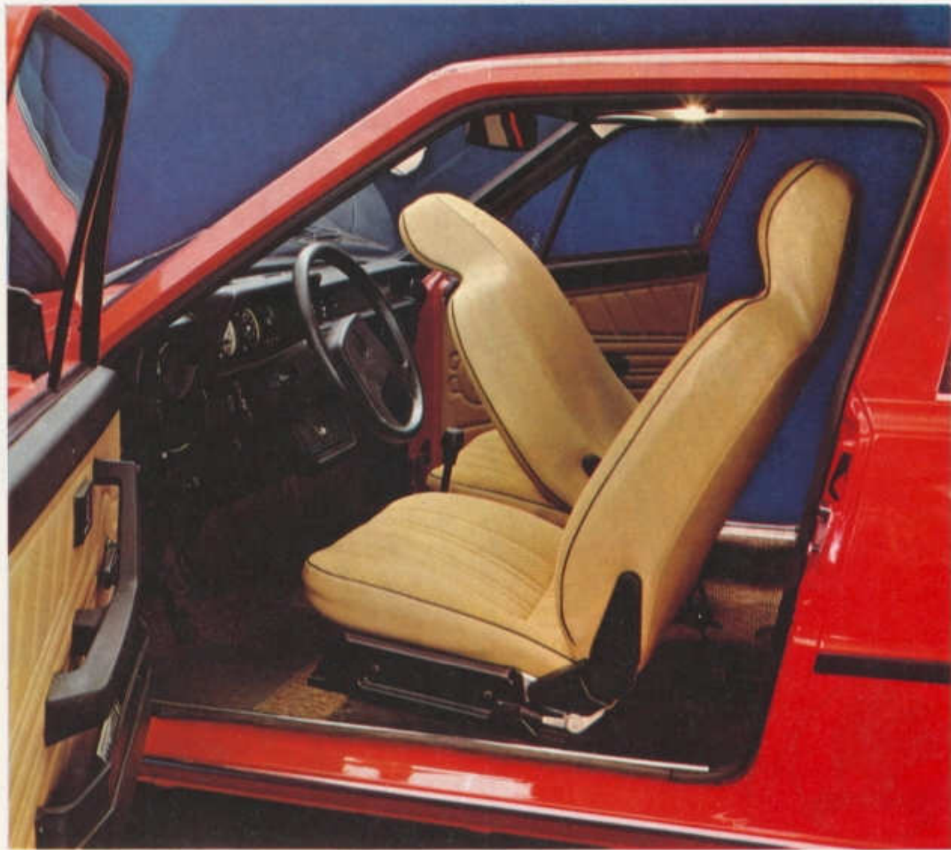
Speciálně konstruované sedačky anatomického charakteru s nastavitelnou opěrkou hlavy
