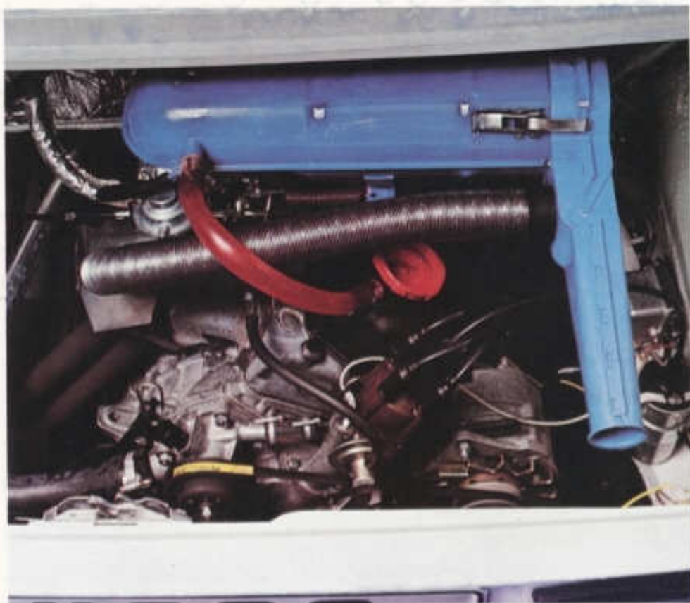
Uložení hnacího agregátu modelu 105 s regulací teploty nasávaného vzduchu
