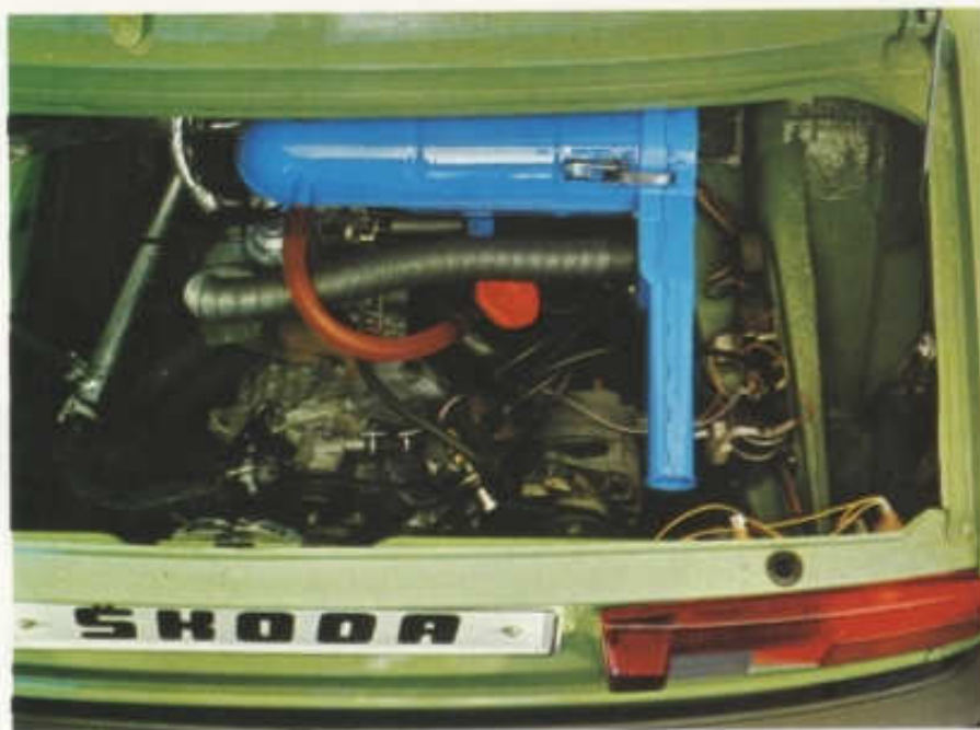
Uložení hnacího agregátu s regulací teploty nasávaného vzduchu
