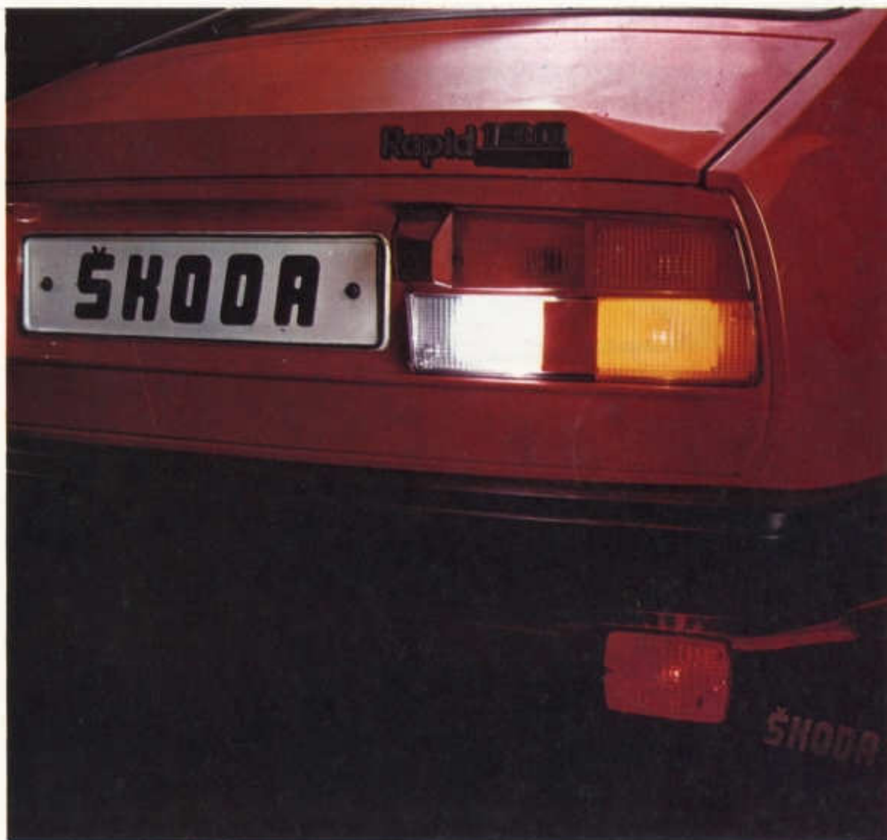
Pod nárazníkem zadní mlhové světlo, ovladatelné z paluby vozu samostatným vypínačem
