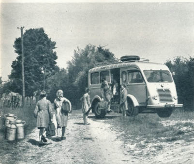
Solution pratique et moderne du "ramassage" des écoliers l'AUTOBUS SCOLAIRE, réalisé à partir du fourgon tôlé 1400 kg, assure le transport confortable de 26 enfants.
